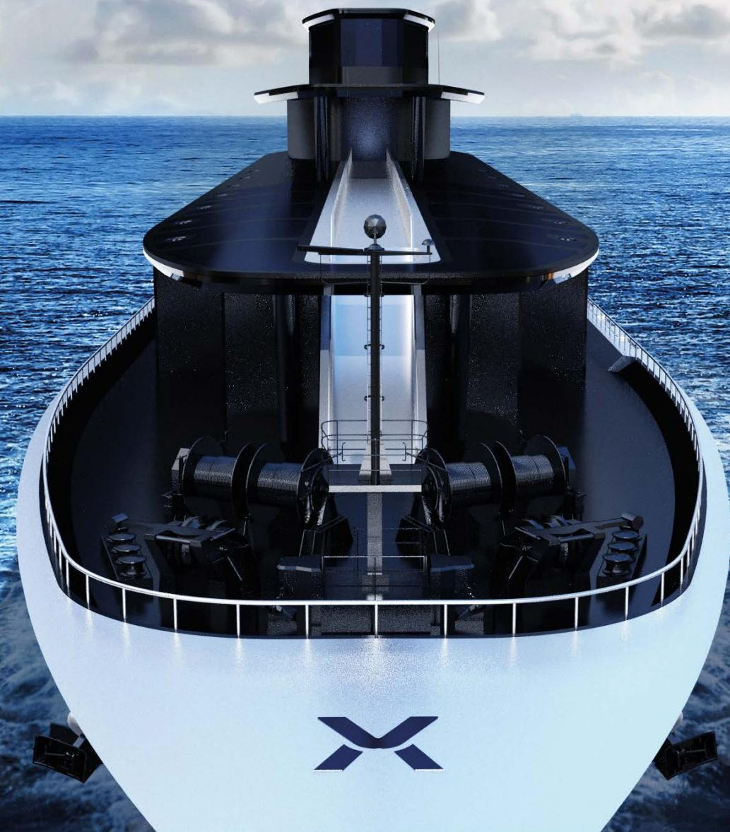
El primer buque cisterna Ark 100 tendrá propulsión eléctrica, contará con una eslora de 140 metros y llevará 96 grandes baterías marinas, con una capacidad total de almacenamiento eléctrico de 241MWh.
